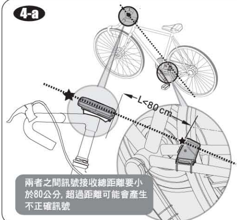
無線踏板迴轉數感測發射器位置可安裝在 a 或 b 位置上
